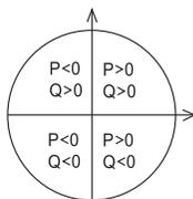
其中P > 0，累计的有功电能是有功电能吸收，P < 0，累计的有功电能是有功电能。释放Q > 0，累计的无功电能是无功电能感性，Q < 0，累计的无功电能是无功电能容性。
