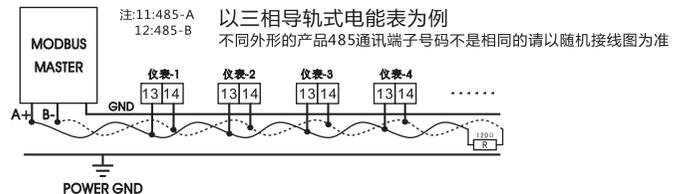
MODBUS-RTU通讯协议:MODBUS协议在一根通讯线上采用主从应答方式的通讯连接方式。首先主计算机的信号寻址到一台唯一地址的终端设备(从机)，然后终端设备发出的应答信号以相反的方向传输给主机，即在一根单独的通讯线上信号沿着相反的两个方向传输所有的通讯数据流(半双工的工作模式)。
